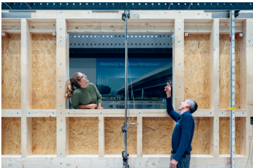
Nadja Manser und ihr Team untersuchen die horizontale Traglast von Wänden in Holzrahmenbauweise, die Fensteröffnungen enthalten.
