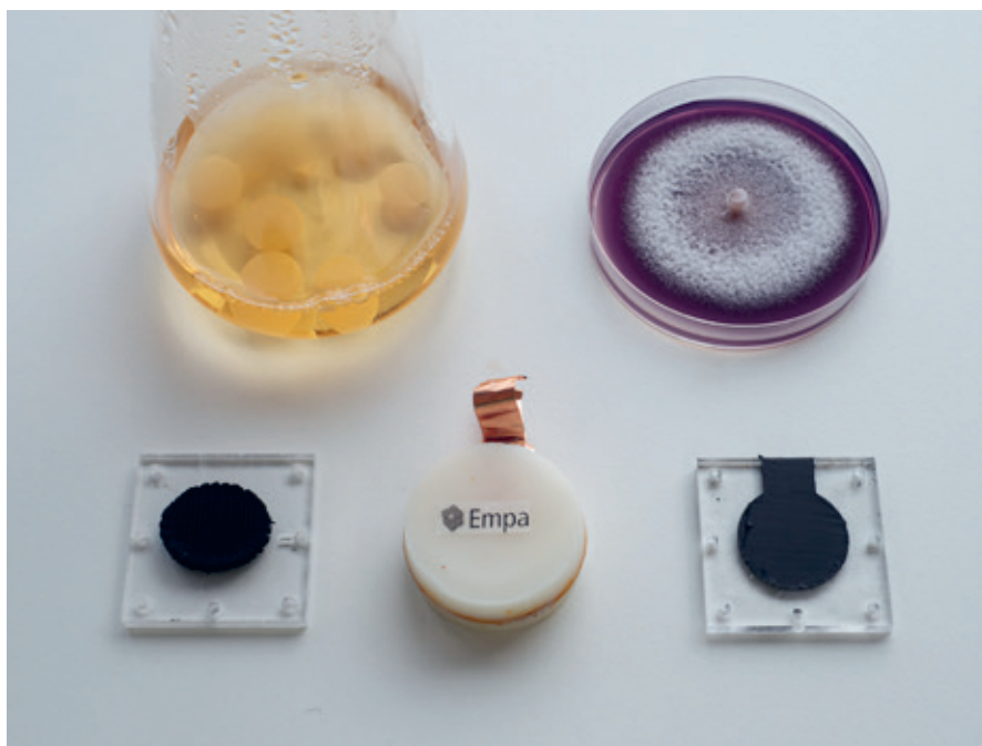
Zwei Pilze (oben) und ihr Stoffwechsel setzen Energie frei. Die Batterie entsteht mit einer Tinte aus Cellulose mit 3D-Druck. Unten in der Mitte: die Pilzbatterie, umschlossen von einer Bienenwackapsel.
