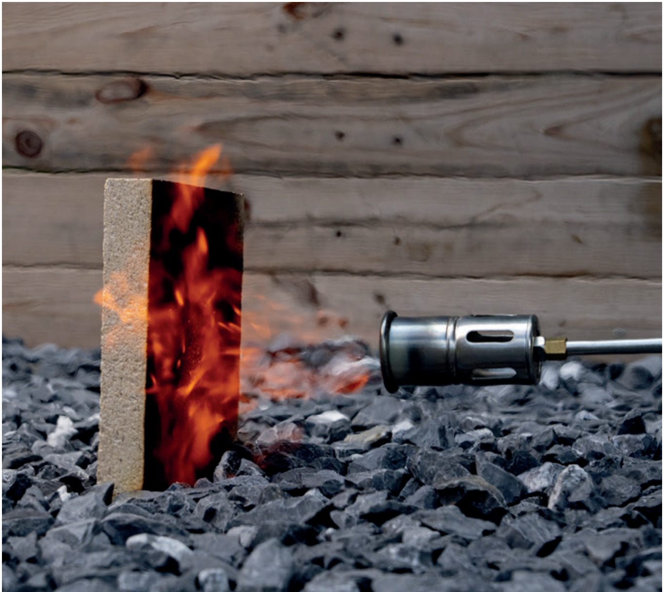
Das neue Material aus Sägemehl und Mineralbinder ist ein hervorragender Brandschutz.
