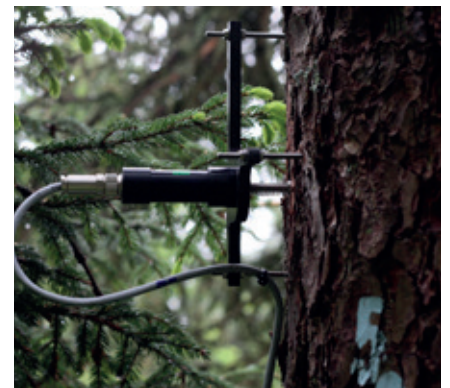
Punktdendrometer werden am Stamm montiert und messen kontinuierlich und im Mikrometerbereich, wie sich der Baumstamm ausdehnt und zusammenzieht.
