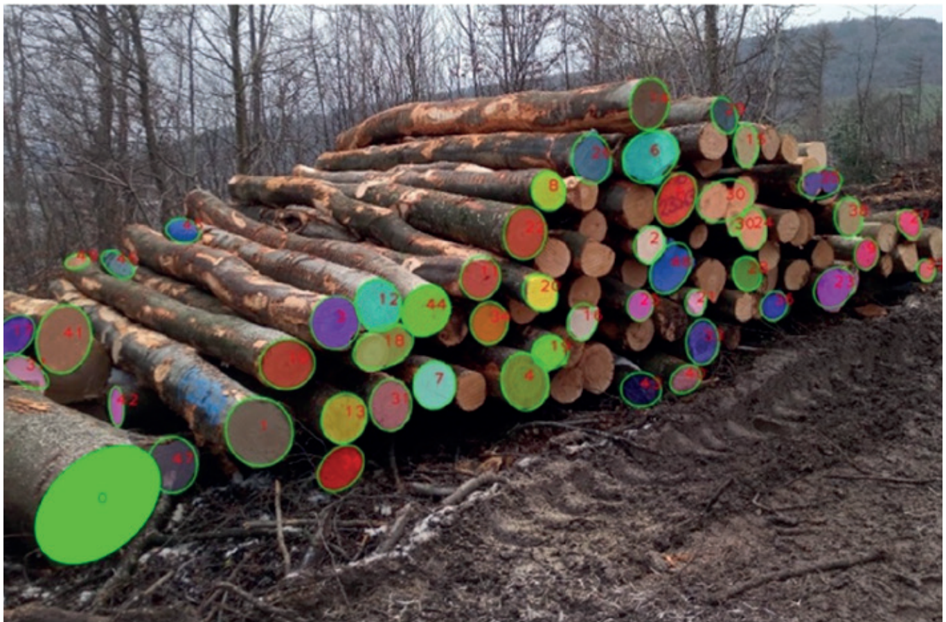
Vermessung der Stammdurchmesser als Ergebnis aus dem ersten Proof-of-Concept von DeepForest.
