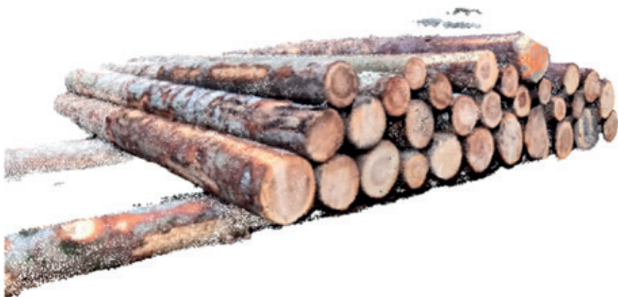
3D-Rekonstruktion als Basis für die Vermessung.
